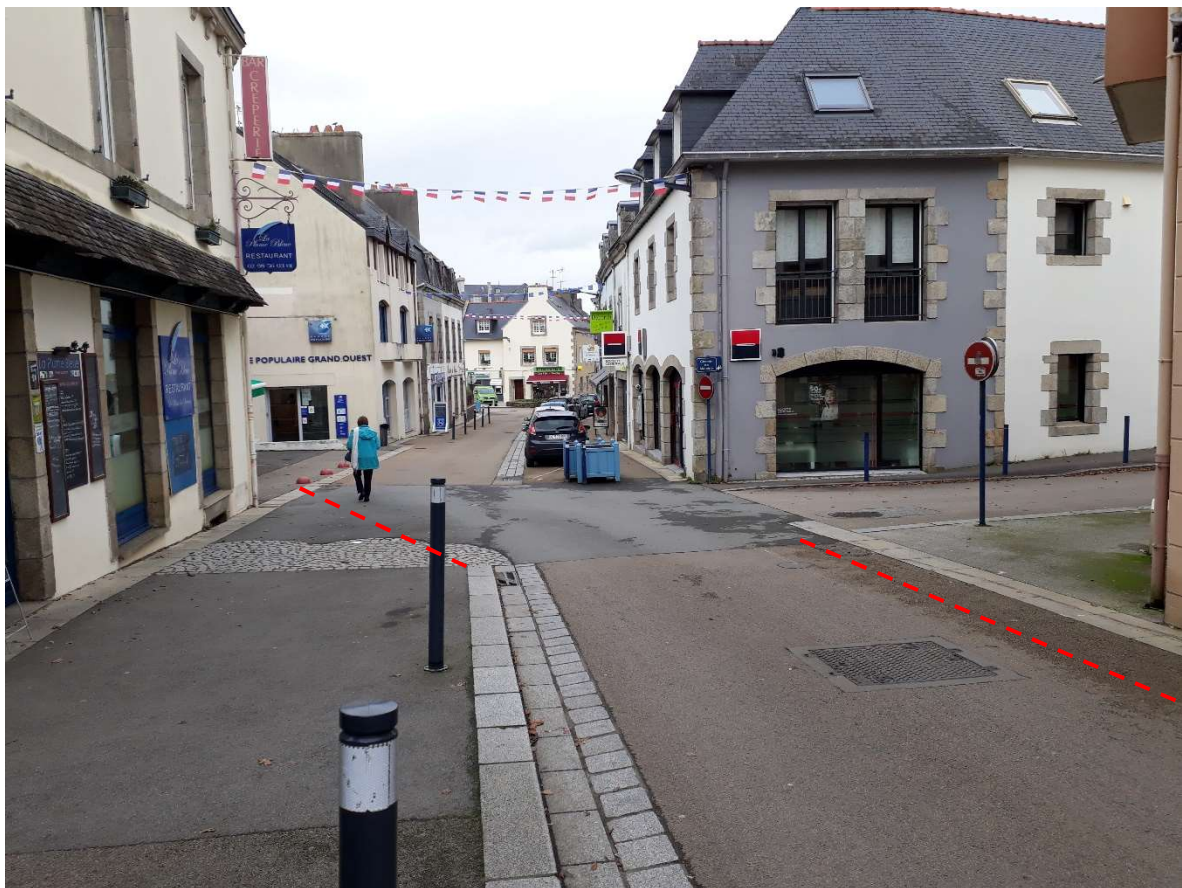
Défaut de matérialisation du cheminement piétonnier (absence de marquage au sol ou différence de matériaux)
