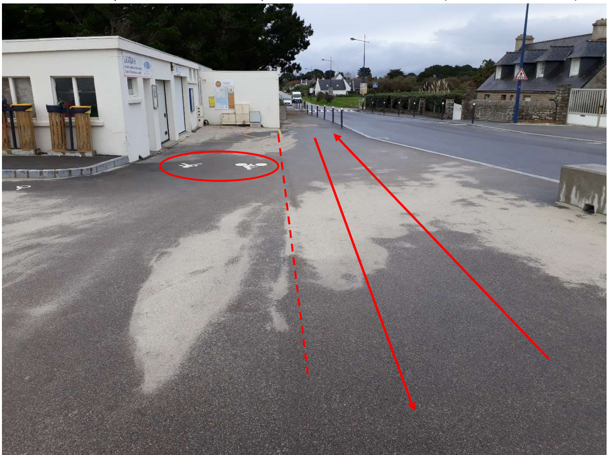
Le placement actuel des symboles devant le bâtiment au bord de la plage ne tient pas compte des cheminements d'usage réel (absence de marquage fréquent au sol pour diriger les flux – limites, sens de circulation des cycles, zones de présence des piétons, signalement de la présence de véhicules -places PMR, marquage au sol de la voie)
